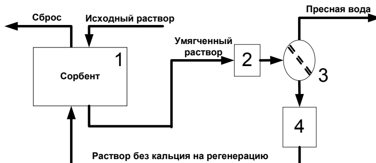
Рис.1. Схема «самоподдерживающегося» процесса умягчения - опреснения. 1 - колонна с катионообменной смолой, 2 – опреснительный бак, 3 – опреснитель (мембрана или нагревательный элемент), 4- накопитель рассола.
